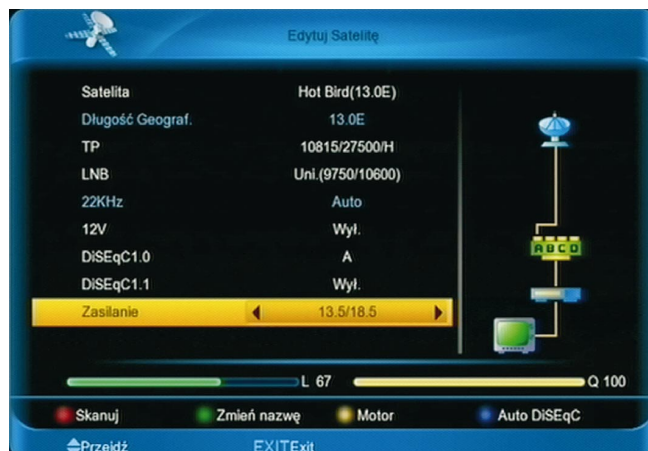
W edycji satelity przewidziano podniesienie napięcia zasilania konwertera (13,5 / 18,5 V). Funkcja przydatna w przypadku instalacji z bardzo długim kablem.
